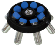
5R-12角式转头 50ml×8孔 6000rpm/5150×g
