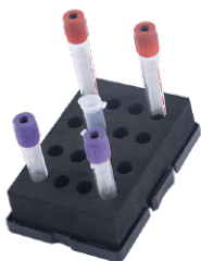
M8-6夹具 5/8ml×16孔 1500rpm
