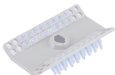
MiniL-A-2转头 0.2ml×12孔×4排 7000rpm/2210×g
