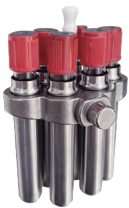
4005水平挂篮 5ml×24孔 4000rpm/2540×g
