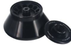
20R A-9角式转头 10ml×12孔 13000rpm/15315×g
