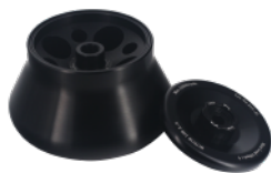
16R A-8角式转头 100ml×4孔 12000rpm/15940×g
